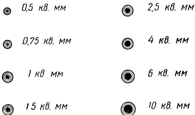
Рис. 43. Сечения изолированных проводов в натуральную величину.
